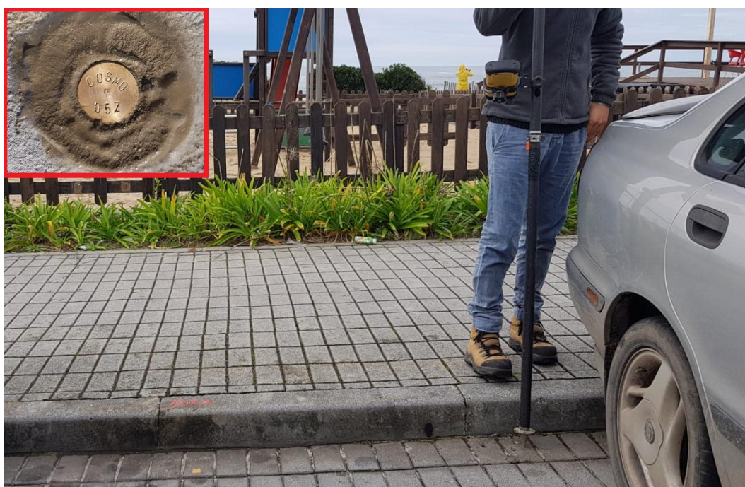
Figura 1 | Marca de bronze utilizada para testemunho e validação de coordenadas na tarefa 1 e 5
